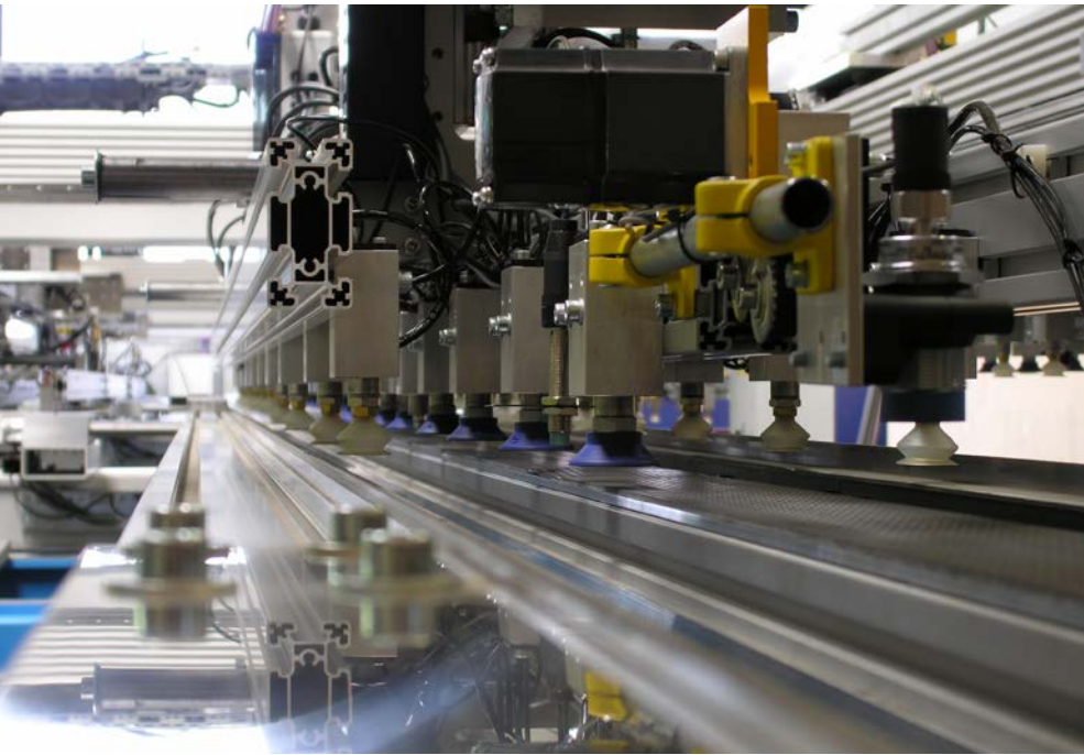
La banda passante di 2500 Hz offre tempi assestamento minimi risultanti in tempi ciclo brevi.
